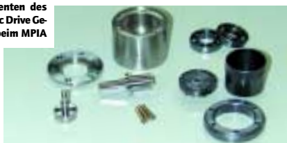
Der Kryo-Aktuator bestehend aus einem Phytron-Schrittmotor und Harmonic Drive Getriebebox
