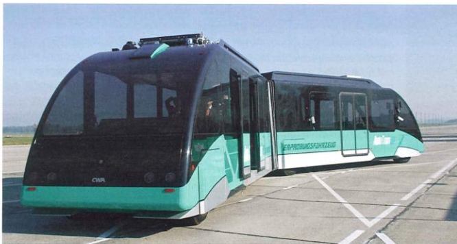
Kombinierte SuperCap-Batteriespeicher, sogenannte Dualspeicher, sind für Anwendungen in Straßen- oder Schienenfahrzeugen gut geeignet. So lassen sich SuperCaps an den Dockingstationen der AutoTram-Traktionsenergie für Fahrstrecken bis zu 2 km innerhalb von 15 s aufnehmen Bild: Fraunhofer IWS
